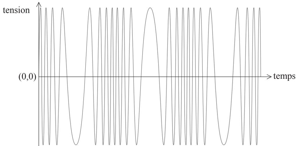
Cette onde porteuse est modulée par un signal monofréquence.
