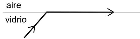
Se pone a continuación una capa de líquido sobre el vidrio sin cambiar el ángulo de incidencia. El índice de refracción del vidrio es mayor que el índice de refracción del líquido y el índice de refracción del líquido es mayor que el del aire.
