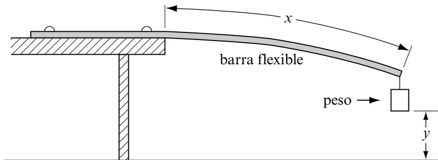
Se fija a una mesa un extremo de una barra flexible. El otro extremo de la barra se extiende a una distancia de  $x$  metros, a partir del extremo de la mesa. Se fija un peso en el extremo de la barra y se mide la distancia,  $y$  metros, desde la base del peso hasta el suelo.
