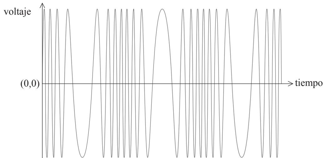
La onda portadora está modulada por una señal de frecuencia única.
