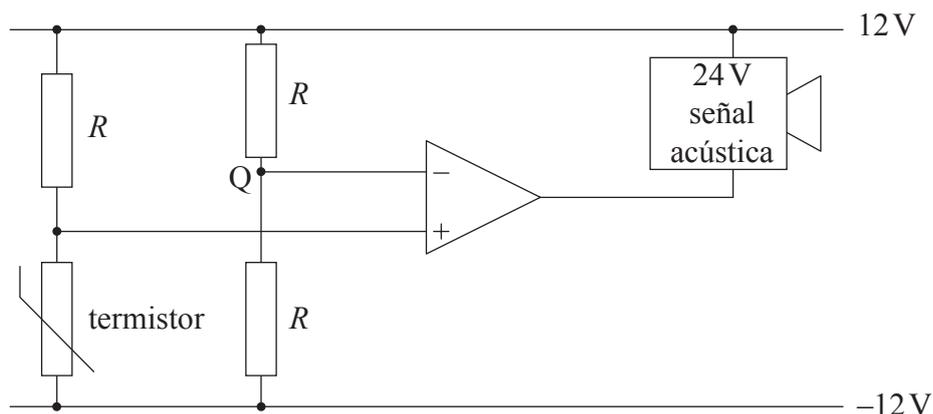
Se requiere que la señal acústica suene cuando la temperatura del termistor exceda los  $50^{\circ}\text{C}$ .
