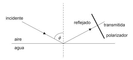
El eje de transmisión del polarizador está inicialmente en horizontal. Se hace rotar el polarizador un ángulo  $\theta$  en torno al rayo reflejado. Sobre los ejes, esquematice una gráfica que muestre la variación con  $\theta$  de la intensidad transmitida I.
