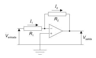
Demuestre que la ganancia del amplificador es  $\frac{V_{\text{salida}}}{V_{\text{entrada}}} = -\frac{R_2}{R_1}$ . [3]
