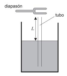
Se hace sonar un diapasón sobre el tubo. Para ciertos valores de L, se forma una onda estacionaria en el tubo.
