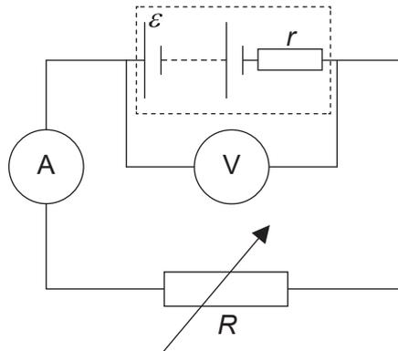
Se ajusta el resistor variable  $R$  y se registran los valores de la diferencia de potencial  $V$  en la célula y de la corriente  $I$ . ¿Qué gráfica muestra la variación de  $V$  con  $I$ ?
