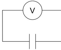
La capacité de ce condensateur est  $6,0 \mu\text{F}$  et la lecture du voltmètre est  $12 \text{ V}$ .
