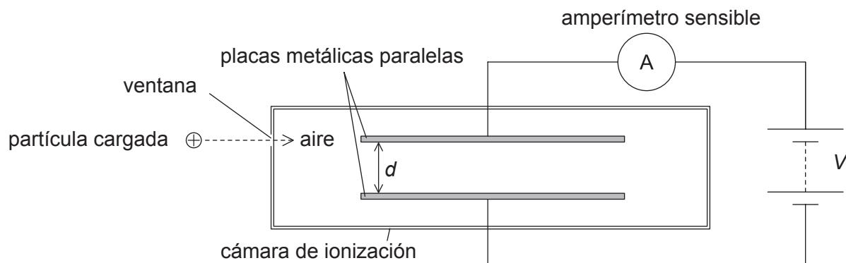
Las partículas cargadas entran en la cámara por una ventana delgada. Entonces, ionizan el aire existente entre las placas metálicas paralelas. Una alta diferencia de potencial entre las placas crea un campo eléctrico que hace que los iones se muevan hacia las placas. Así, la carga circula en el circuito y un amperímetro sensible detecta la corriente.
