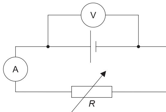
Se ajusta el resistor variable para tomar una serie de lecturas de voltaje y corriente. La gráfica muestra la variación con  $R$  de la potencia disipada en la pila y la potencia disipada en el resistor variable.
