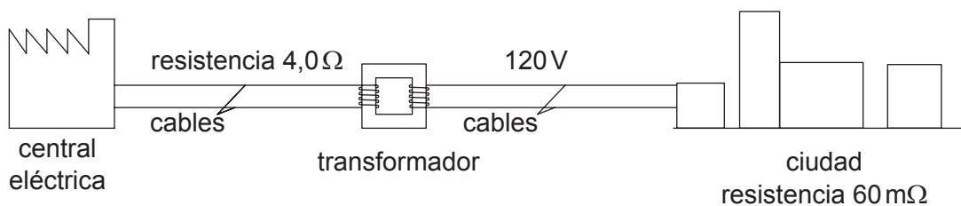
Los cables de transmisión desde la central eléctrica hasta el transformador tienen una resistencia total de  $4,0\Omega$ . El transformador tiene un rendimiento del 90 % y reduce el voltaje hasta 120 V. En el momento de la demanda máxima de potencia, la resistencia efectiva de la ciudad y de los cables desde el transformador hasta la ciudad es de  $60\text{m}\Omega$ .
